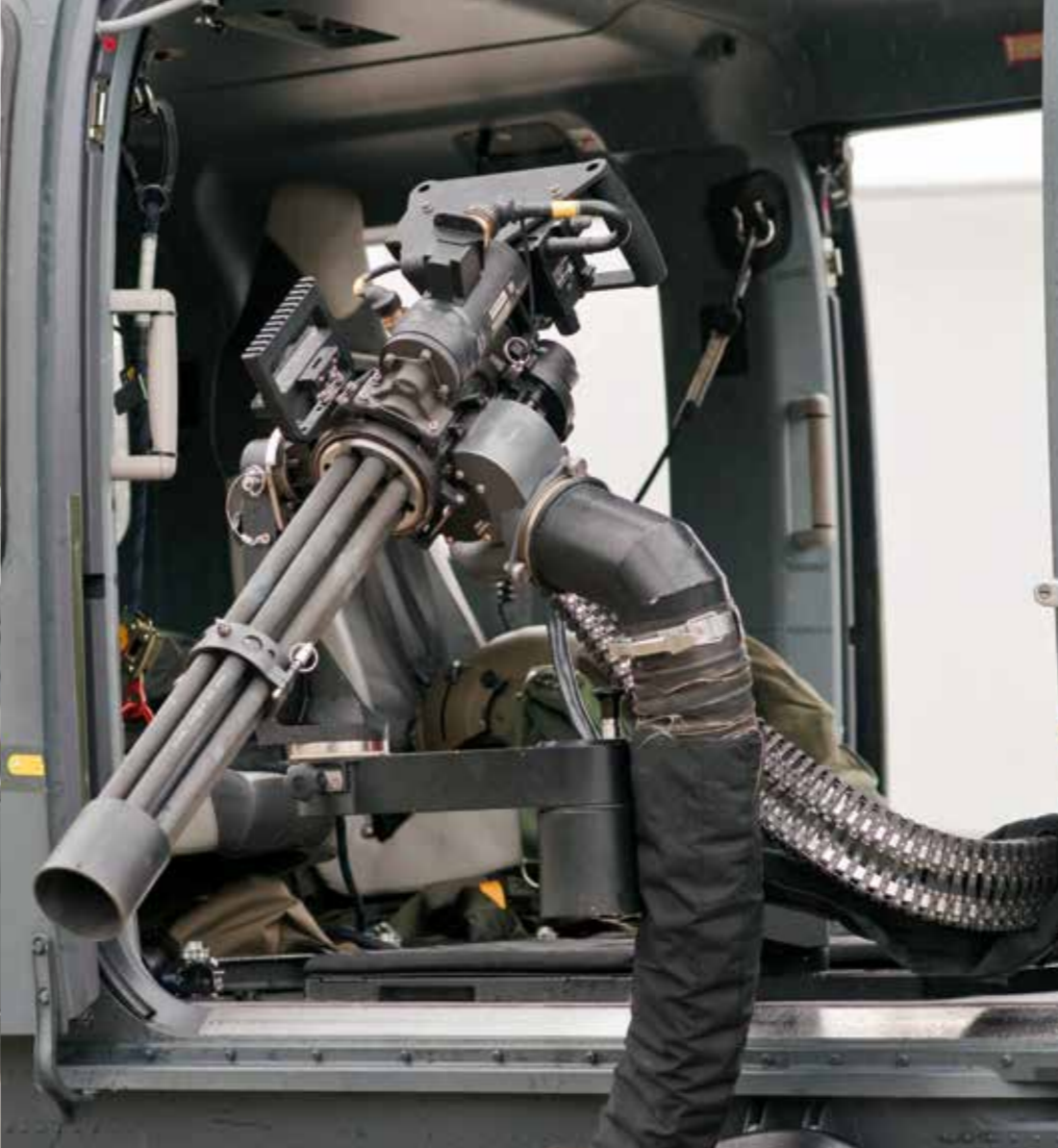
Oben: Der Arbeitsplatz des TacOp. Das M134D-H (Hybrid) Gatling-Maschinengewehr der Bundeswehr ist eine verbesserte Variante in Leichtbauweise. Die Bezeichnung „Hybrid“ kennzeichnet die Minigun von der Firma Dillon Aero als eine Mischbauweise aus Stahl- und Titanelementen.
