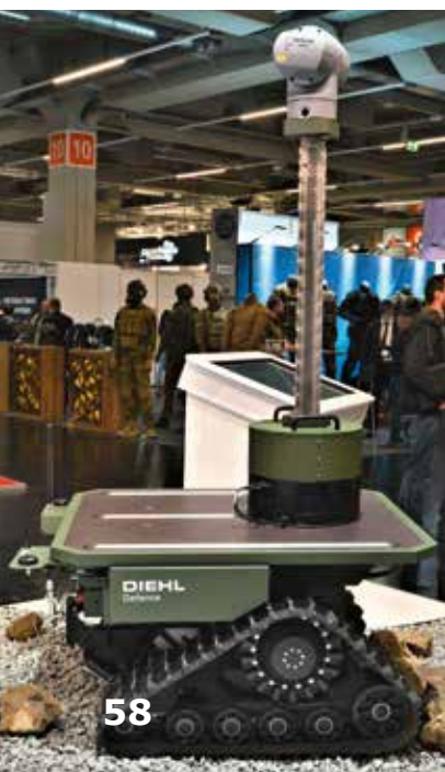
Oben: Das M134D-HHB von Dillon Europe GmbH war praktisch in einer EOS-Waffenstation von Diehl Defence verbaut (auf Polaris ATV). Die Waffenstation ist mit Tag-/Nachtoptiken und mit einem Radar zur Aufklärung, Zielverfolgung und zur Schussabgabe ausgerüstet, so die Erkenntnis vor Ort. Unten: AirScout Sentry auf Kette und Zippermast sowie Diehl Defence HPEM C-UAS Effector.
