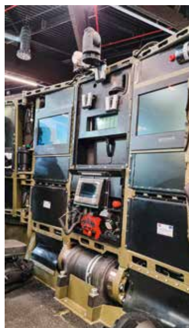
Ganze Seite: Die kroatische Firma DOK-ING Ltd. zeigte eindrucksvoll ihren neuen gepanzerten MV-3 „Hystrix“ Counter Terror Traktor in der Funktion als halboffenes Angriffs- und Räumfahrzeug. Das durch Ketten angetriebene Vehikel verfügt über neun Kameras und zwei LCD-Displays. Dazu kommen Detektoren für Gase, Ramme und ca. 700 kg Payload. Mehrere Einsatzkräfte finden hinter dem Schutzschild Platz. Dieses verfügt auch über Schießluken und geschützte Beobachtungsfenster.
