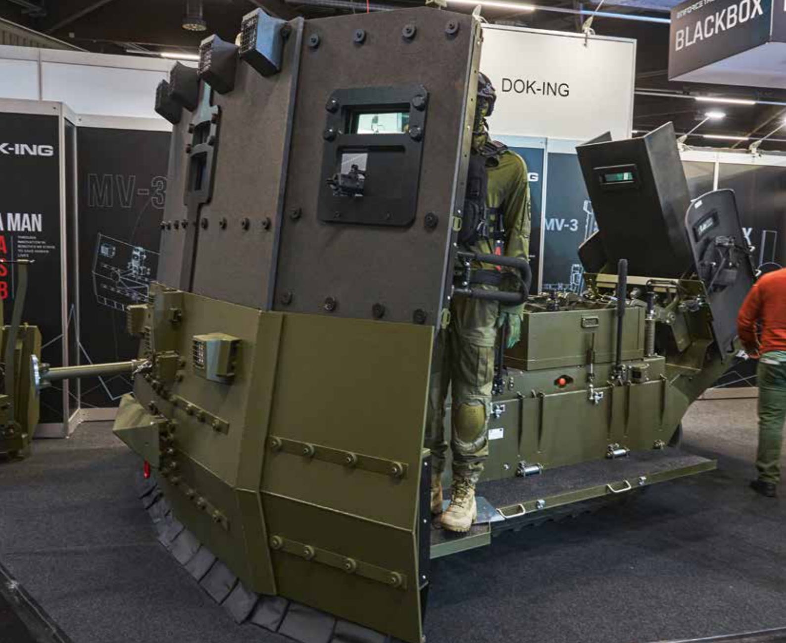
Ganze Seite: Die kroatische Firma DOK-ING Ltd. zeigte eindrucksvoll ihren neuen gepanzerten MV-3 „Hystrix“ Counter Terror Traktor in der Funktion als halboffenes Angriffs- und Räumfahrzeug. Das durch Ketten angetriebene Vehikel verfügt über neun Kameras und zwei LCD-Displays. Dazu kommen Detektoren für Gase, Ramme und ca. 700 kg Payload. Mehrere Einsatzkräfte finden hinter dem Schutzschild Platz. Dieses verfügt auch über Schießluken und geschützte Beobachtungsfenster.
