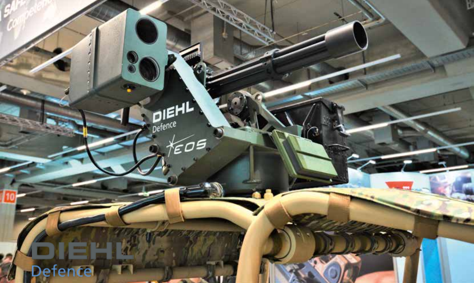
Oben: Das M134D-HHB von Dillon Europe GmbH war praktisch in einer EOS-Waffenstation von Diehl Defence verbaut (auf Polaris ATV). Die Waffenstation ist mit Tag-/Nachtoptiken und mit einem Radar zur Aufklärung, Zielverfolgung und zur Schussabgabe ausgerüstet, so die Erkenntnis vor Ort. Unten: AirScout Sentry auf Kette und Zippermast sowie Diehl Defence HPEM C-UAS Effector.
